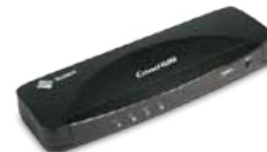
SUNIX BP 盒是一款通用的 RS-232 串口扩展设备，是为解决目前大多数个人电脑 (PC)、8 位单片机、16 位单片机 UART 串口太少，因而无法连接多台 RS-232 设备而特别设计的专用串口扩展设备。SUNIX BP 盒实现一口 RS-232 分时转接扩展四口 RS-232 通信，BP 盒内 CPU 针对 4 个下行 RS-232 接口进行智能检测，一旦检测到某一通道 RS-232 通讯信号，CPU 即将该通道 RS-232 通讯信号与主口连接，并拒绝其他通道占用主机口，只有当该口通讯结束后主口释放，进入新一轮检测，当 CPU 检测到该口超过 1 秒钟无通讯信号，则作超时处理进入下一轮检测。
