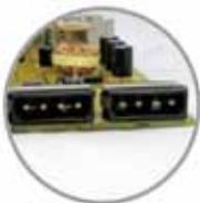
为了获得有效的电流输出, 板卡上设计有两组 4 针脚电源连接器。一组 4 针脚电源提供 +12V 直流输出, 并可以转换到 +24V 直流。另一个提供 +5V 和 +12V 直流输出为另外的供电型 USB 端口使用。
